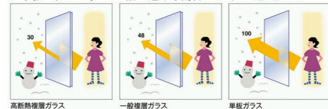
■ 単板ガラスに対しての熱の逃げる割合 ガラス厚3mm、空気層12mm
