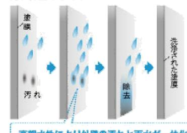
高親水性により外壁の汚れと雨水が一体化
