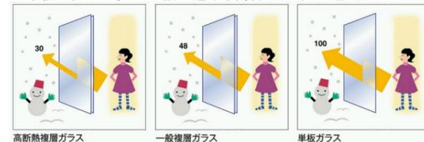
■各種複層ガラスの紫外線カット比較 ガラス厚3mm、空気層12mm
